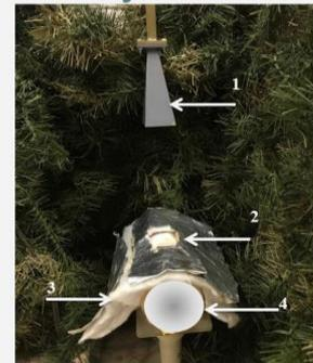
1 – рупор антенны генератора для воздействия ИГМИ,
